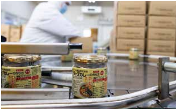
ニーダーで製造したスープカレーの素は、検査の後、瓶に充填する。1日の製造量は400ケース(4800個)。夏に製造のピークを迎える
