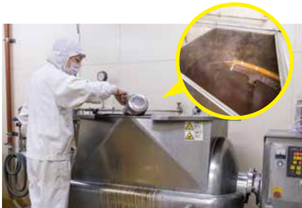
一度に最大500リットルの材料を混ぜ込むことができるニーダー。加熱しながら材料を練り込み、10分ほどでスープカレーの素が完成
