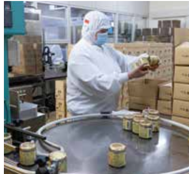
最終の箱詰め工程。異物が混入していないか、日付は間違っていないか、目視で確認する
