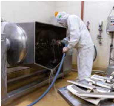
洗浄作業はなによりも大事。製造後はすべての部品を分解して隅々まで丁寧に手洗する
