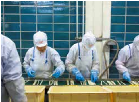
工場に運ばれた原料はすぐに選別され、ライン工程中の機械で根元のカット、鱗片(りんぺん)除去を行う
