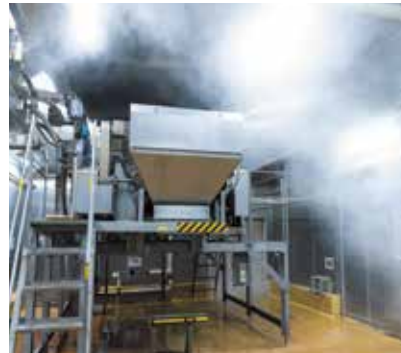
もやし生産で最大の敵は雑菌。原料種子を85℃のお湯で殺菌してから栽培が始まる
