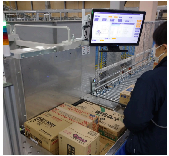
ディスプレイに指示された通りに箱を積む様子
